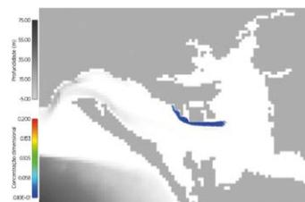
**Figura 3:** Pluma da descarga da Navigator. A escala representa a razão entre a concentração em cada ponto e a concentração no efluente. O valor mínimo representado é 0,01 e, por conseguinte, fora desta zona a pluma está diluída mais de 100 vezes. A cor azul representa diluição superior a 20 vezes.
