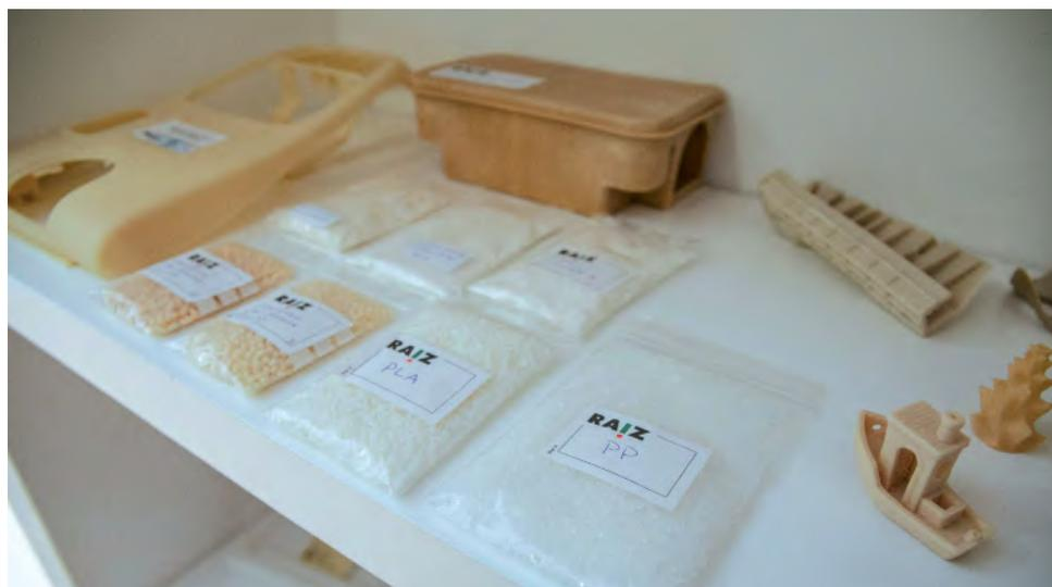
Biocompósitos: são misturadas fibras celulósicas com materiais termoplásticos, preferencialmente bioplásticos.
