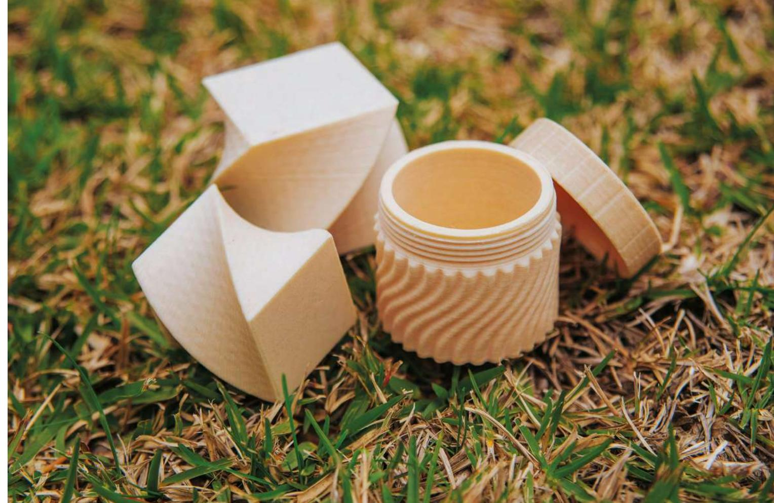
Compósitos termoplásticos com elevada incorporação de celulose.
